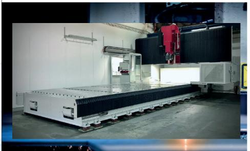
Wir fräsen, bohren und drehen entsprechende Materialien nach Kundenzeichnung. Das Rohmaterial wird größtenteils durch unsere Kunden beigestellt, jedoch bieten wir auch die Möglichkeit der Materialbeschaffung durch uns an. Auf einer Produktionsfläche von rund 900 m² fertigen wir Einzelteile bis hin zu Mittel- und Großserien im Klein- und Großteilbereich.
