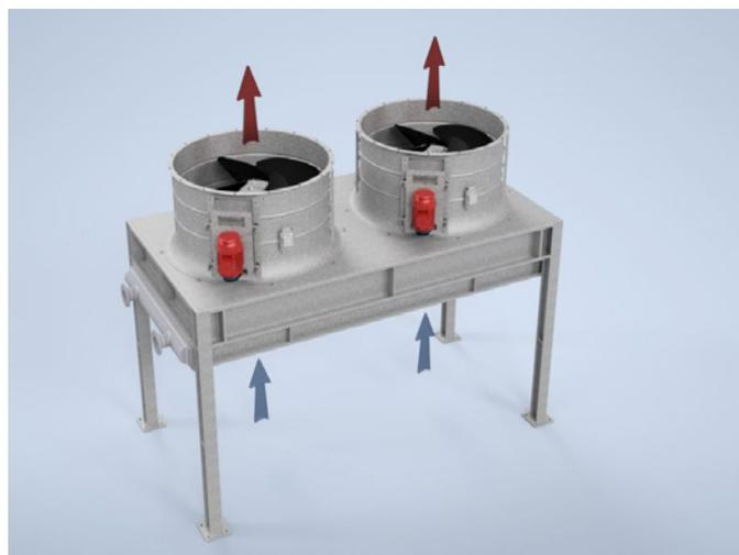
Die saugende Anordnung der Ventilatoren über den Wärmeaustauscherbündeln gewährleistet eine sehr gleichmäßige Anströmung der Wärmeübertragungsfläche. Die Beschattung der Wärmeaustauscherbündel bietet Schutz vor starker Sonneneinstrahlung.
